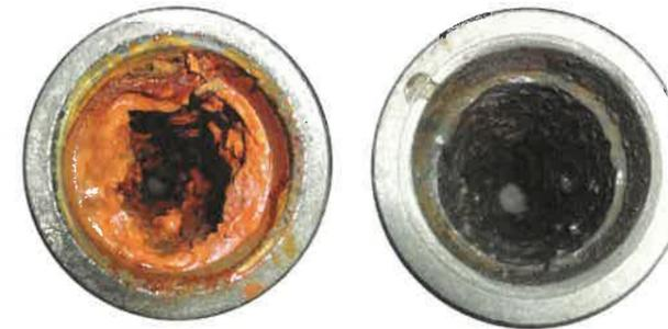
bestehenden Leitung herausgeschnitten, der Zustand fotografiert und dokumentiert. Dieses wird dann wiederum in die Leitung eingebaut. Nach 12 respektive nach 24 Monaten wird das Kontrollrohr ausgebaut, fotografiert und mit dem ursprünglichen Zustand verglichen. Dies erlaubt den beteiligten Fachleuten mit sehr wenig Aufwand den genauen Zustand des Innenlebens der Leitungen zu kontrollieren. So kann auf einfache Weise der Material-Abbau überprüft werden.
